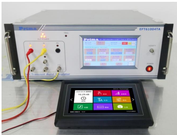
图 6-4 群脉冲测试图
